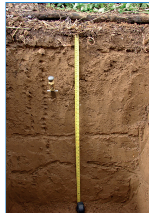
Figura 1. Perfil de suelo del orden Inceptisol. Finca 11, Palmar Sur, Puntarenas, Costa Rica. 2012. Fuente: Ing. Diógenes Cubero Fernández, PhD.
