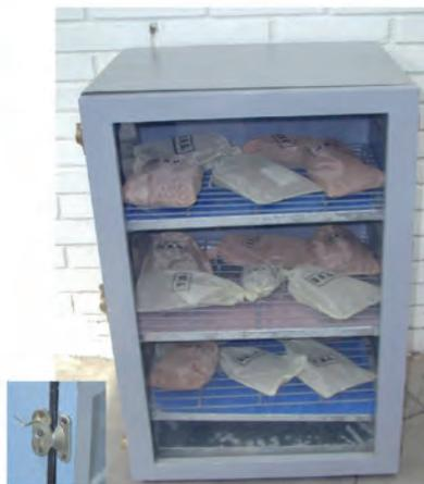
**Figura 17.** Mueble de madera para el secado lento de vainas y semillas, con el empleo de sílica gel (fotografía obtenida de Lima et al., 2009).
