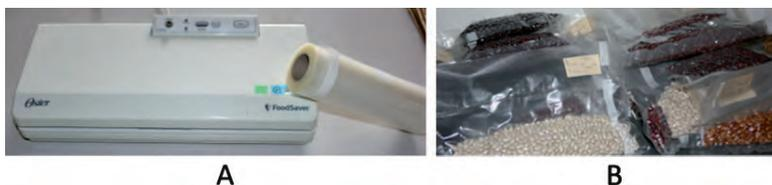
**Figura 9.** Selladora de bolsas plástica, que extrae el aire de la bolsa ("al vacío") (A). Bolsas plásticas selladas y "al vacío" (B).
