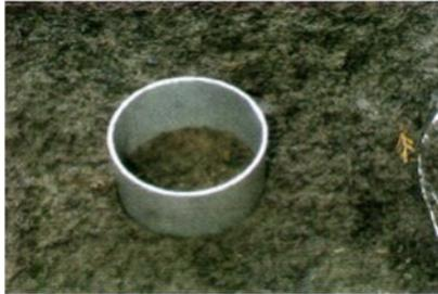
**Figura 7.** Cilindro de acero galvanizado para el muestreo de suelos.
