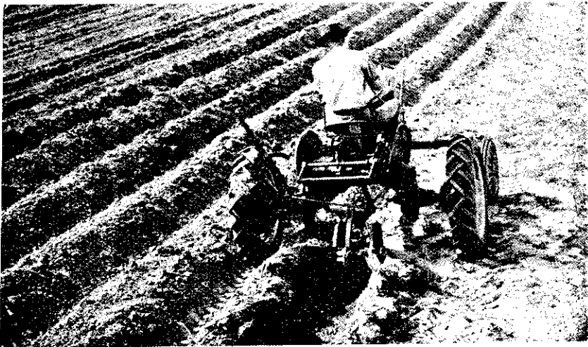
Pequeño tractor "International" arado con un arado surcador de una reja. Bajo condiciones normales este pequeño equipo puede arar 5 manzanas al día con un costo relativamente pequeño de combustible. Una de las ruedas del tractor al cominar sobre el surco anteriormente arado, guarda una perfecta silencia entre surco y surco.
