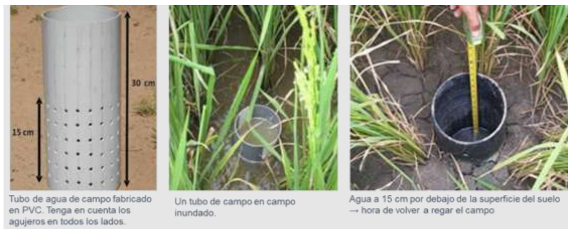
Figura 7. Tubo de agua Pani para monitorear el nivel de agua en el suelo.
